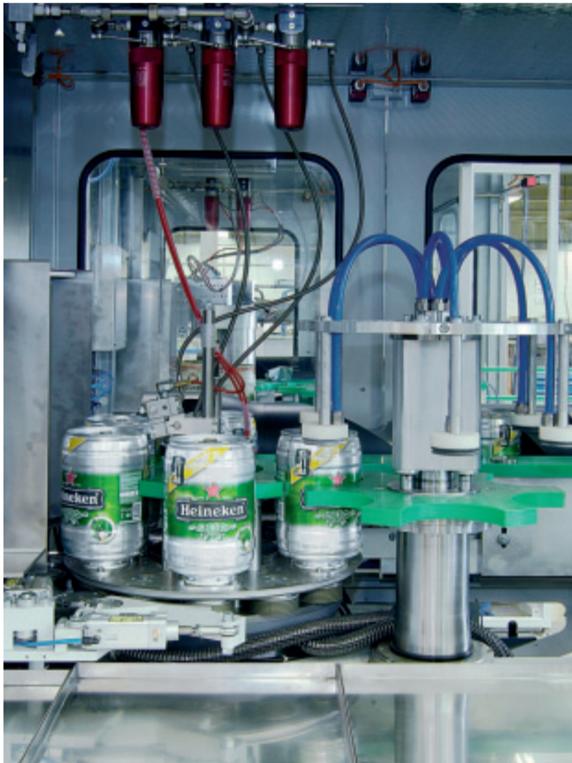
Mit der Innenbeschichtung von Partyfässern sorgt Sprimag für guten Geschmack
