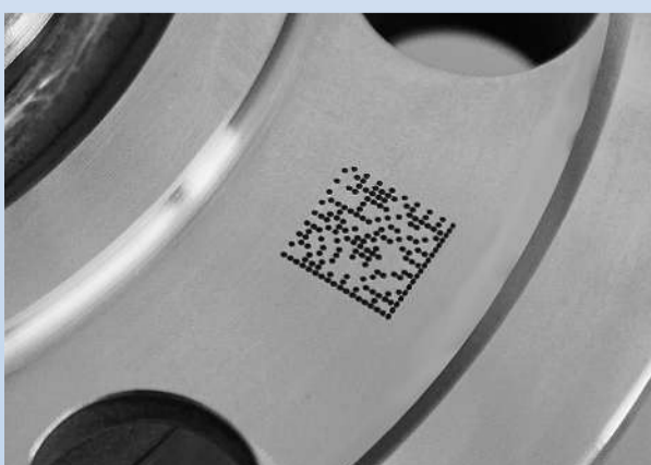
Der Data Matrix Code wird mittels Inkjet auf die Radlager appliziert
