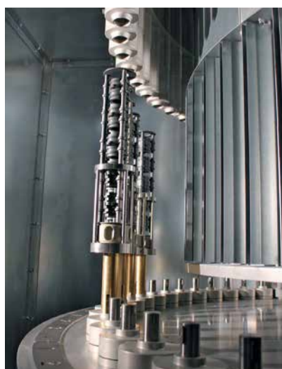
Zwischentrockner mit Ausblasdüsen für gleichmäßige Trocknung der Innenbeschichtung
