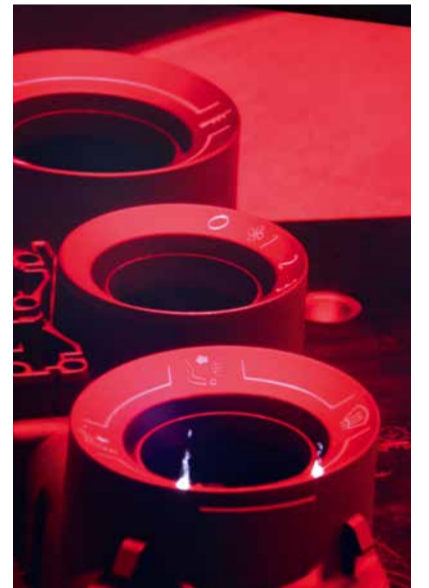
Der erste Kunde von Sprimag Brasil hatte großes Interesse an gelaserten Tag- und Nacht-Kunststoffteilen
