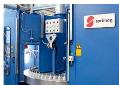
Auf dem kompakten Rundautomaten werden Motorenteile mit Gleitlack automatisch beschichtet
