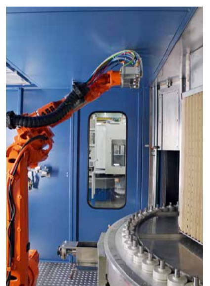
Dank Schnellwechselsystem entfällt das Nachjustieren der Spritzapparate
